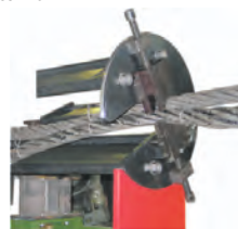
Заведение петли каната в поворотный зажим
