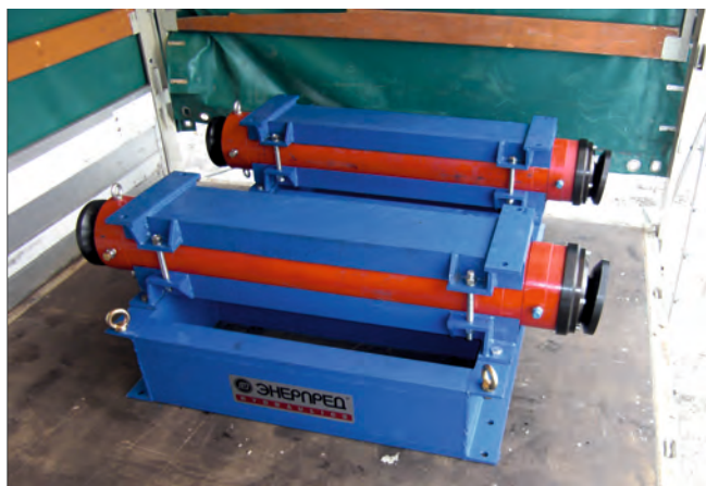
ЦС200Г1250Ш в составе установки для прокола грунта
